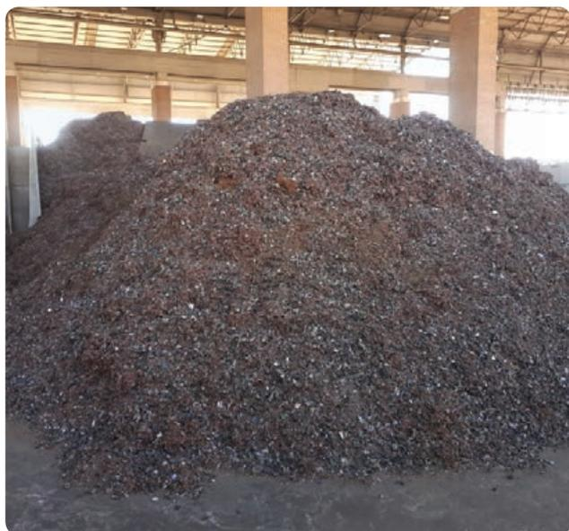
**Fig. 9** Materiale granulato di rame post lavorazione mulino
