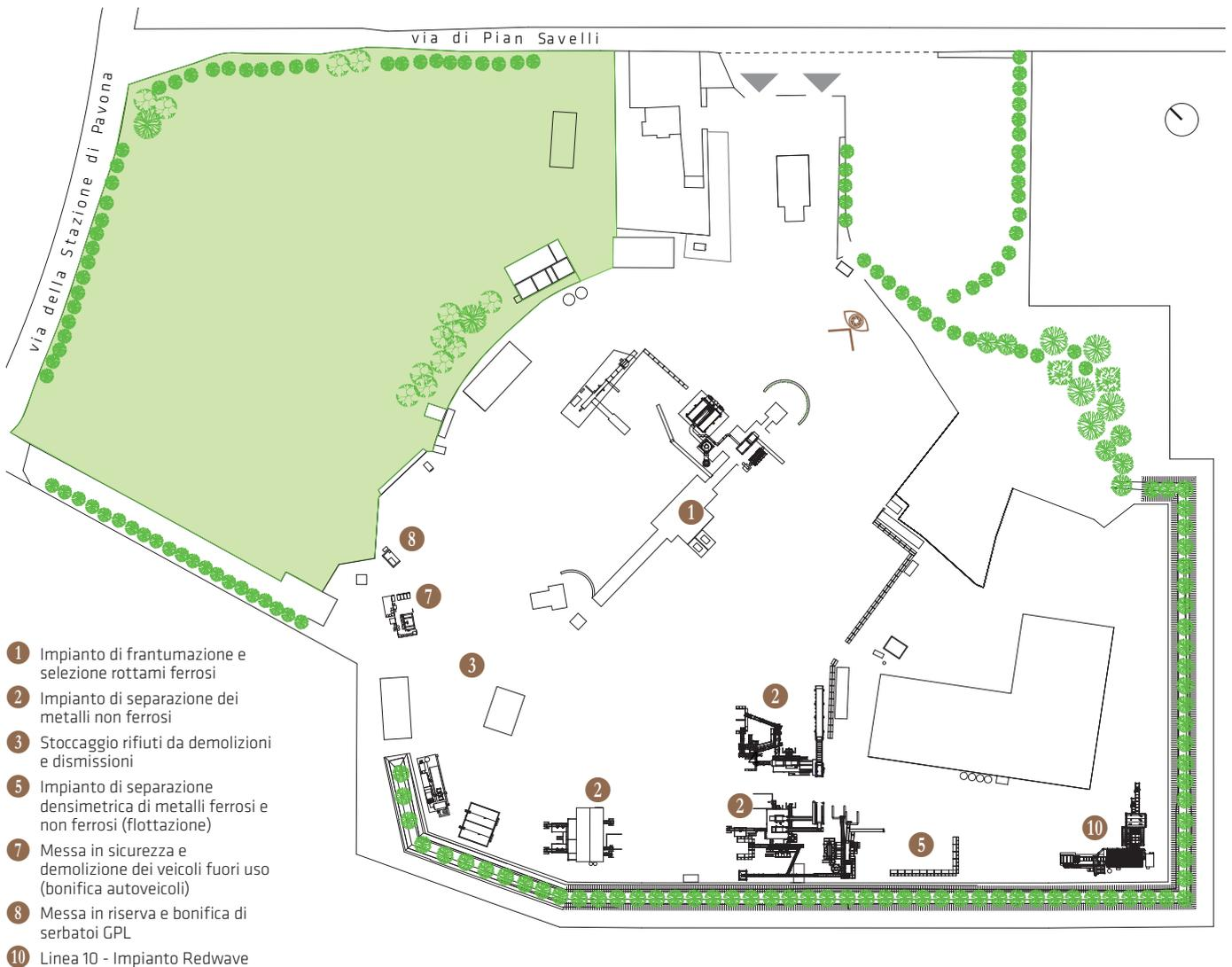
**Fig. 3** Planimetria dell'impianto con l'indicazione dei numeri delle Linee e indicazione del punto di ripresa fotografica
